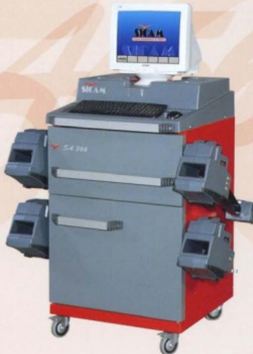
SA 566 型号和 SA 566R 型号的检测器的特色是它们的 6 部 CCD 测量器量度系统。监视器可以同时连续显示实际的量度数字以及制造厂方提供的标准数据，让操作人员在量度和调整的过程中可以作经常和准确的比较。检测器装有最新型的个人计算机，采用 Windows XP(视窗)操作系统以及设有 17" 监视器。检测器的其它优势特色包括：可以量度 20° 或以上的主销倾角，不用电子圆盘的辅助也可以顺利量度主销倾角；为提升车辆调整前轮外倾度；计算前束的变差，还可以选择应用语言；备有客户资料卡并附自动搜寻系统；可以定期更新制造厂方的数据。
